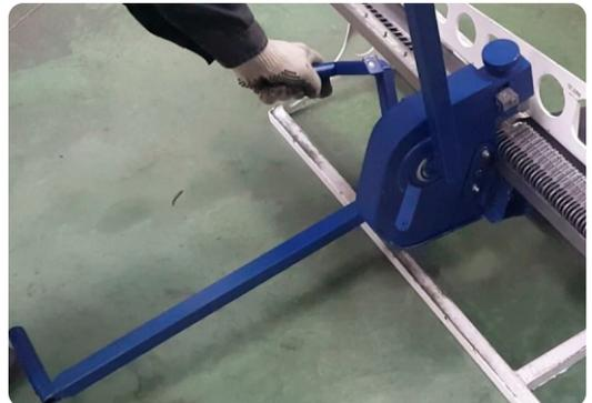
8.1) Первым этапом осуществляется прижатие пластин соединителей и прокол ленточного полотна скобами соединителя по всей его длине с поднятым вверх ограничителем, для предотвращения загиба скобы. По завершению первого этапа соединительное устройство ШС передвигается в конец рейки остова и снимается с направляющих;
