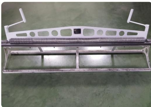
6) Подготовленный край ленточного полотна устанавливается на остов в открытые соединители до упоров на остова и фиксируется прижимной планкой, предусматривая отступ от борта ленты до соединения по 20 - 45 мм с обеих сторон, в зависимости от типа ленты;
